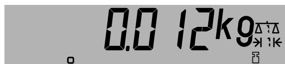
Die Hauptanzeige zeigt die Abweichung von 0.012 kg an.
