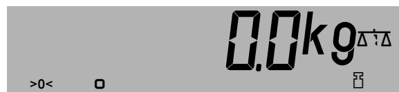
Abb. 18 Wägebrücke wird nullgestellt
